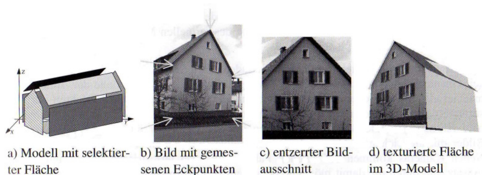
Abbildung 2-2: Verfahrensschritte zur manuellen Texturierung von Fassaden (Coors, Zipf, 2005)
